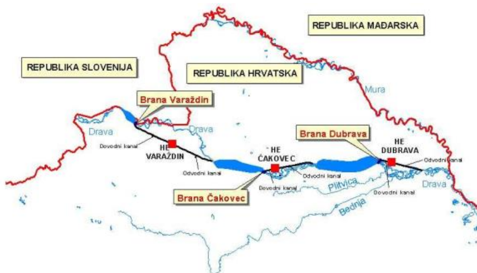
Slika 7: Shematski prikaz hidroenergetskog sustava na rijeci Dravi 34
